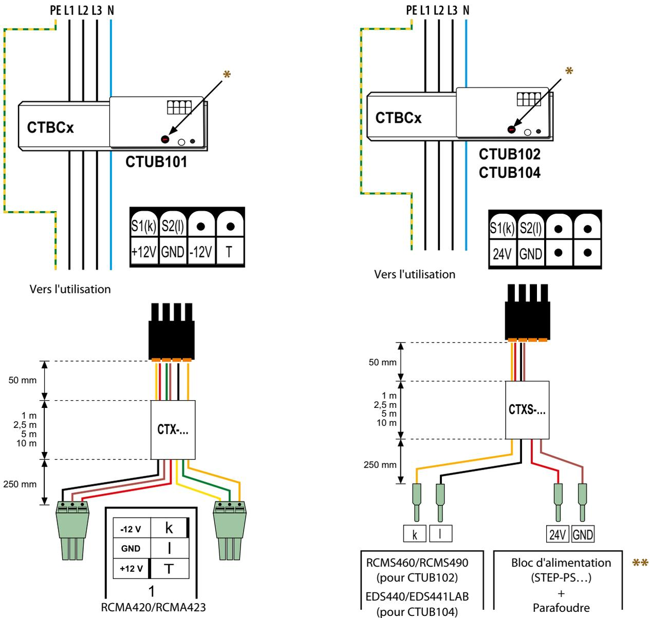
\* La plage de mesure doit être sélectionnée en fonction de la valeur de réponse pré réglée sur le localisateur RCMS460 ou RCMA420/423  $I_{\Delta N}$ . Si une plage de mesure plus étendue est néanmoins sélectionnée, la résolution se détériore. Pour le CTUB104, Il n'est pas nécessaire de sélectionner une plage de mesure.
